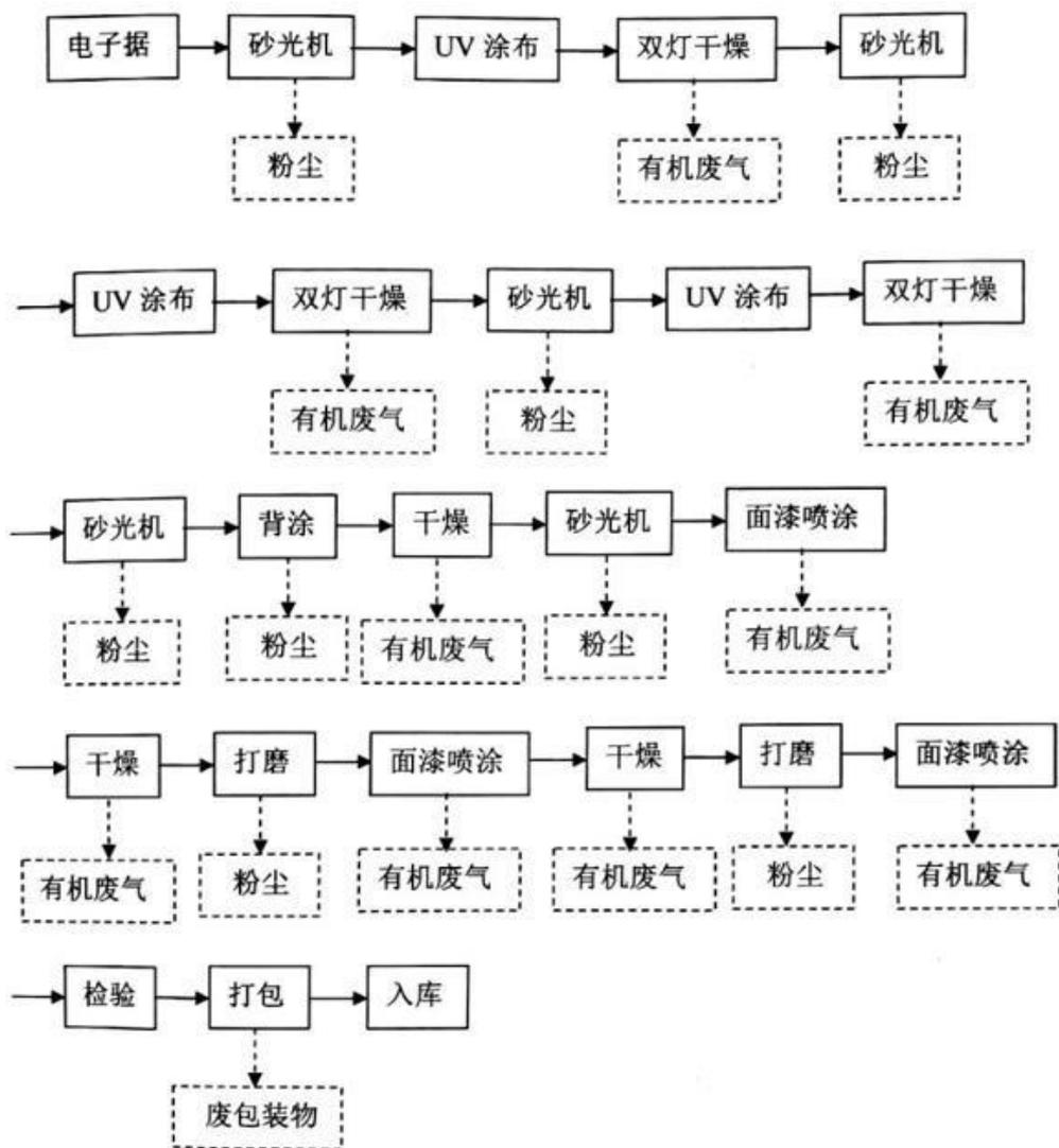
图 3 阅览桌产品生产工艺流程图
